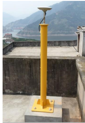
屋顶型基墩实物图
