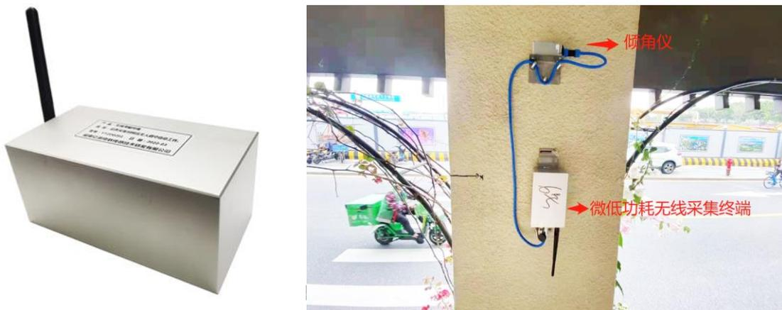
（图一）微低功耗无线采集传输终端产品实物图
