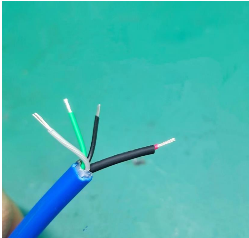
图 6 套上小号热缩管
