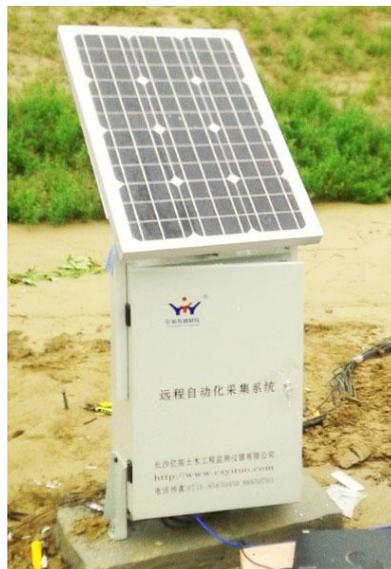
图6 自动化采集机箱实物图
